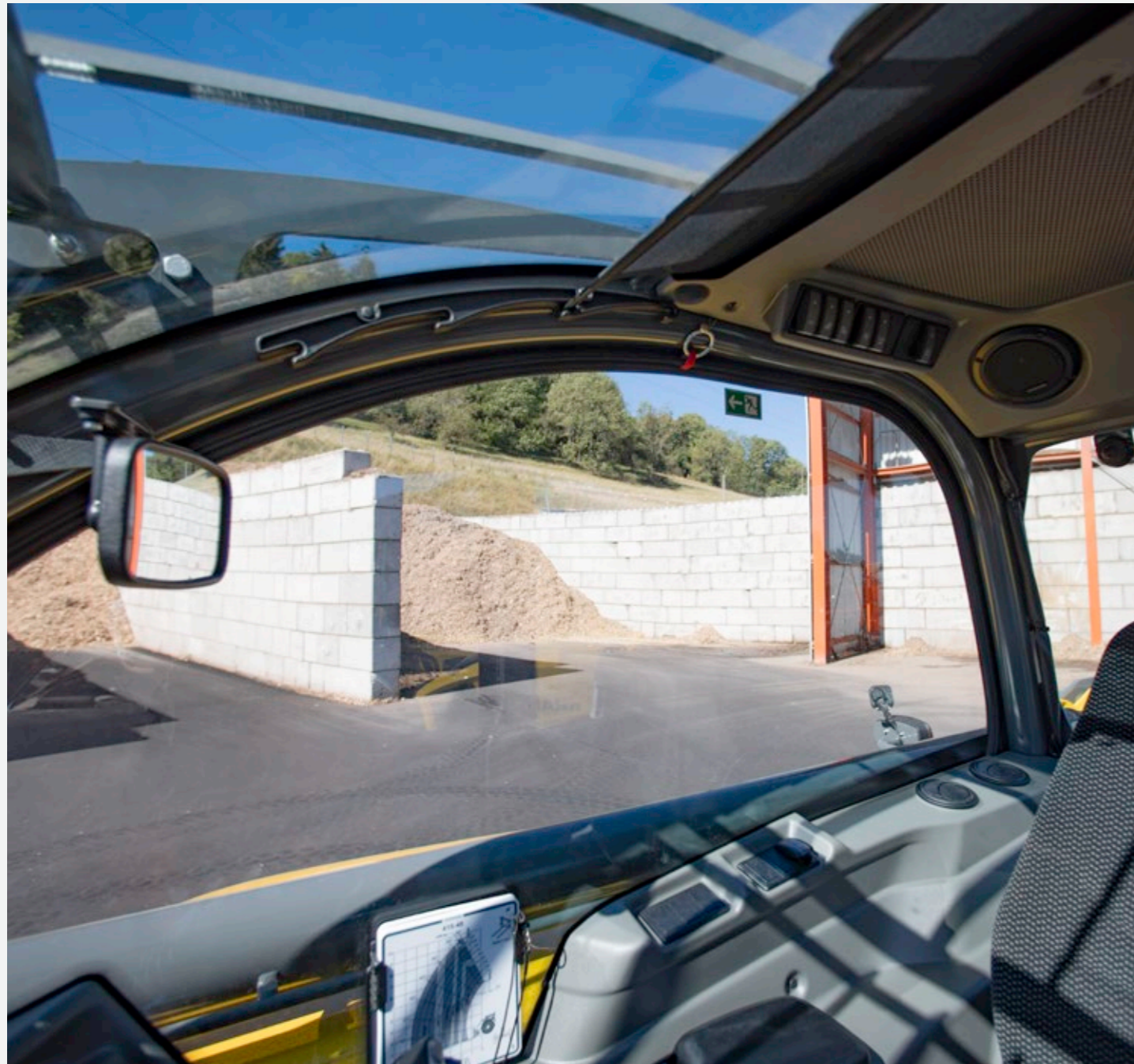
Flache Motorhaube sorgt für eine optimale Sicht zur rechten Seite.
