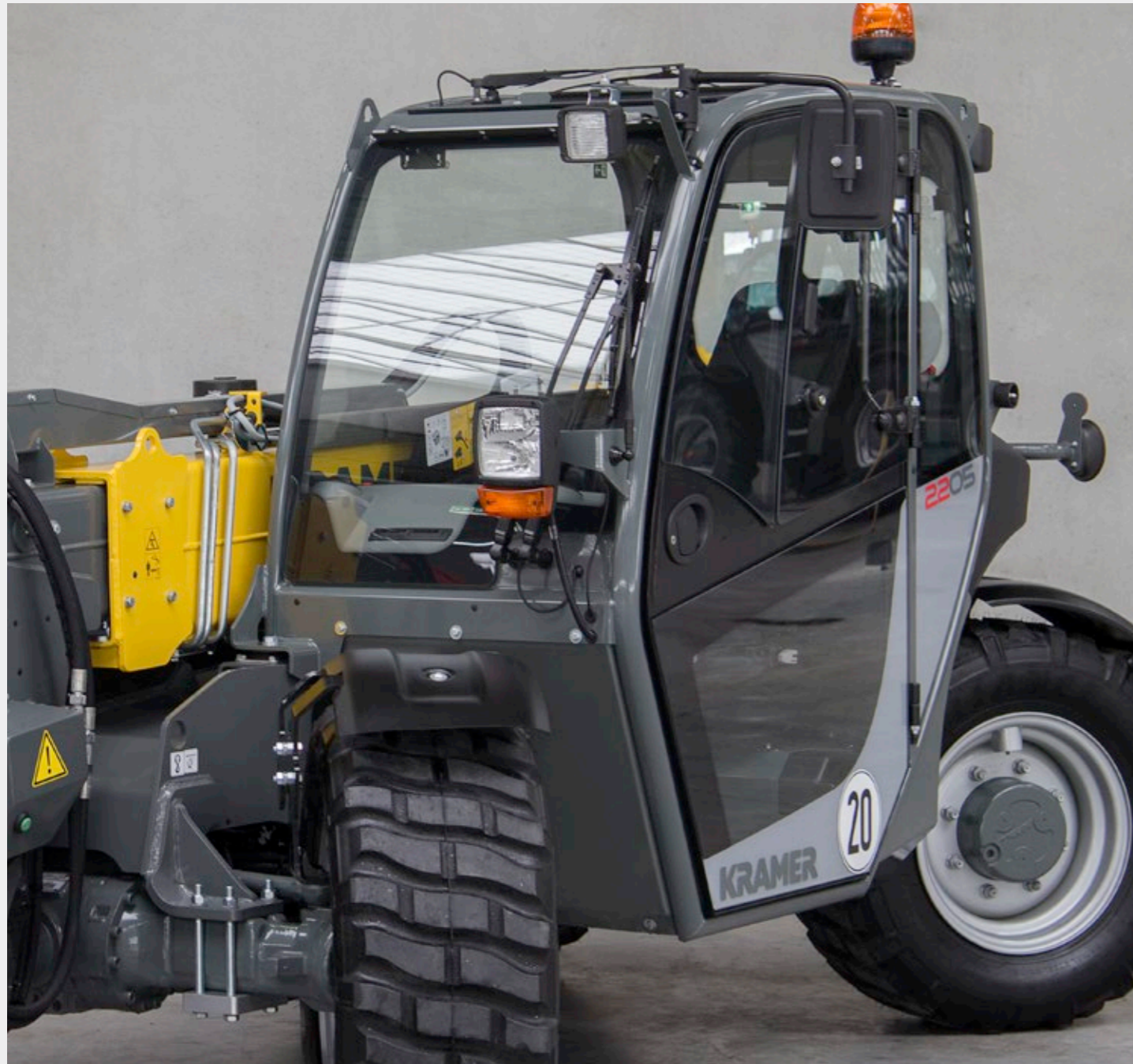
Hervorragende Rundumsicht: Schmale Kabinenholme bieten eine optimale Sicht zu allen Seiten.
